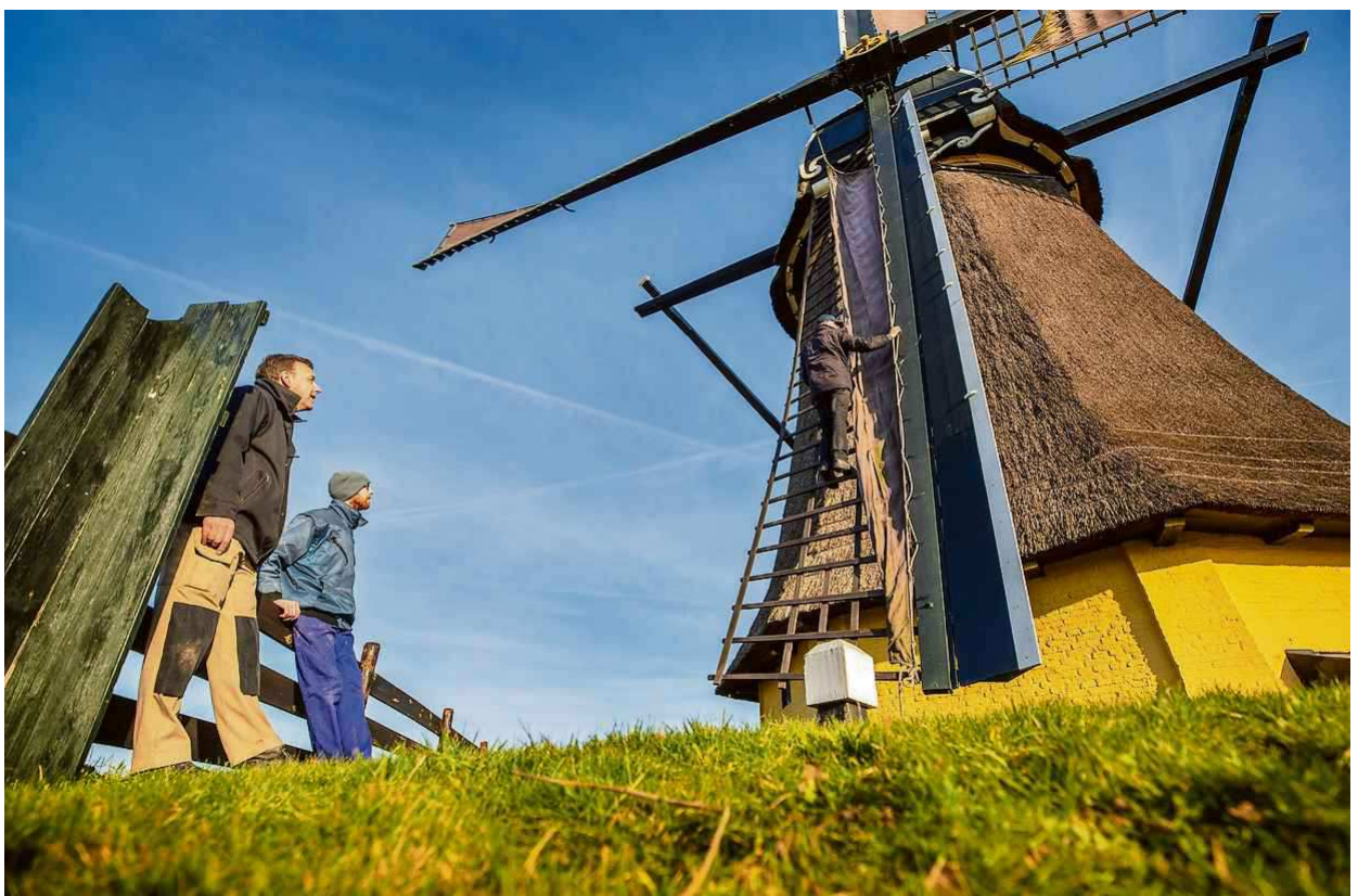
Leermeester Frank van Onna (links) en Wybe Bouma kijken toe hoe Klaas Elzinga het zeil op het gevlucht van de Nijlânnermolen oplegt. FOTO NIELS DE VRIES
